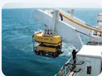
水深2,500mに対応する水中ロボット
