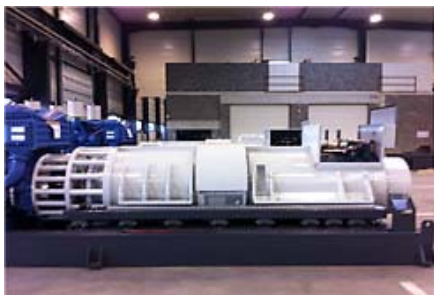
■ ロータリーUPS
