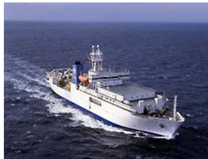
■ケーブル敷設船「すばる」(総トン数9,557トン)
