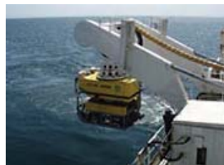
水深2,500mに対応する水中ロボット
