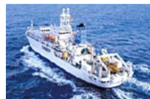
■海底ケーブル敷設船「すばる」
