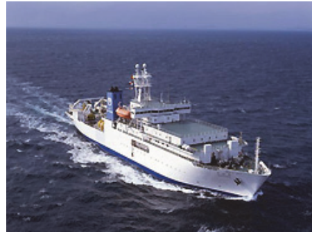
■ 海底ケーブル敷設船「すばる」（総トン数9,557トン）
