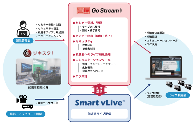
図2. 直伝独自のライブ配信管理システムとSmart vLiveとを連携させた、Go Streamの「超低遅延ライブ」プランの概要(図提供: 直伝)
