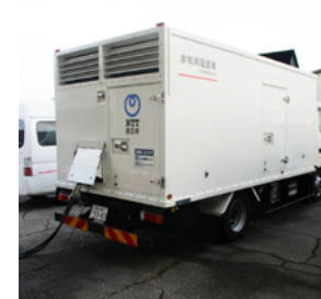
【NTT西日本非常用電源車】
