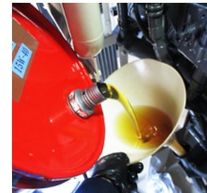
【潤滑油交換作業】
