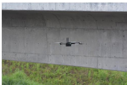
【Visionで建設中の橋梁周辺を自動飛行する様子】
