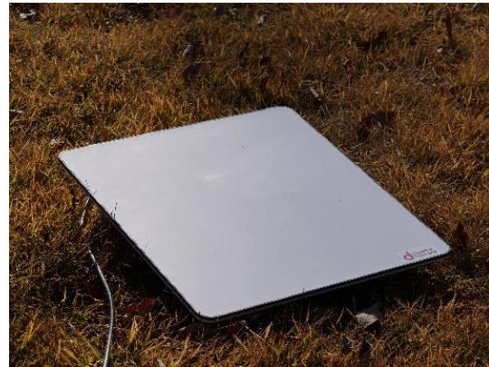
<現地に設置された Starlink アンテナ>
